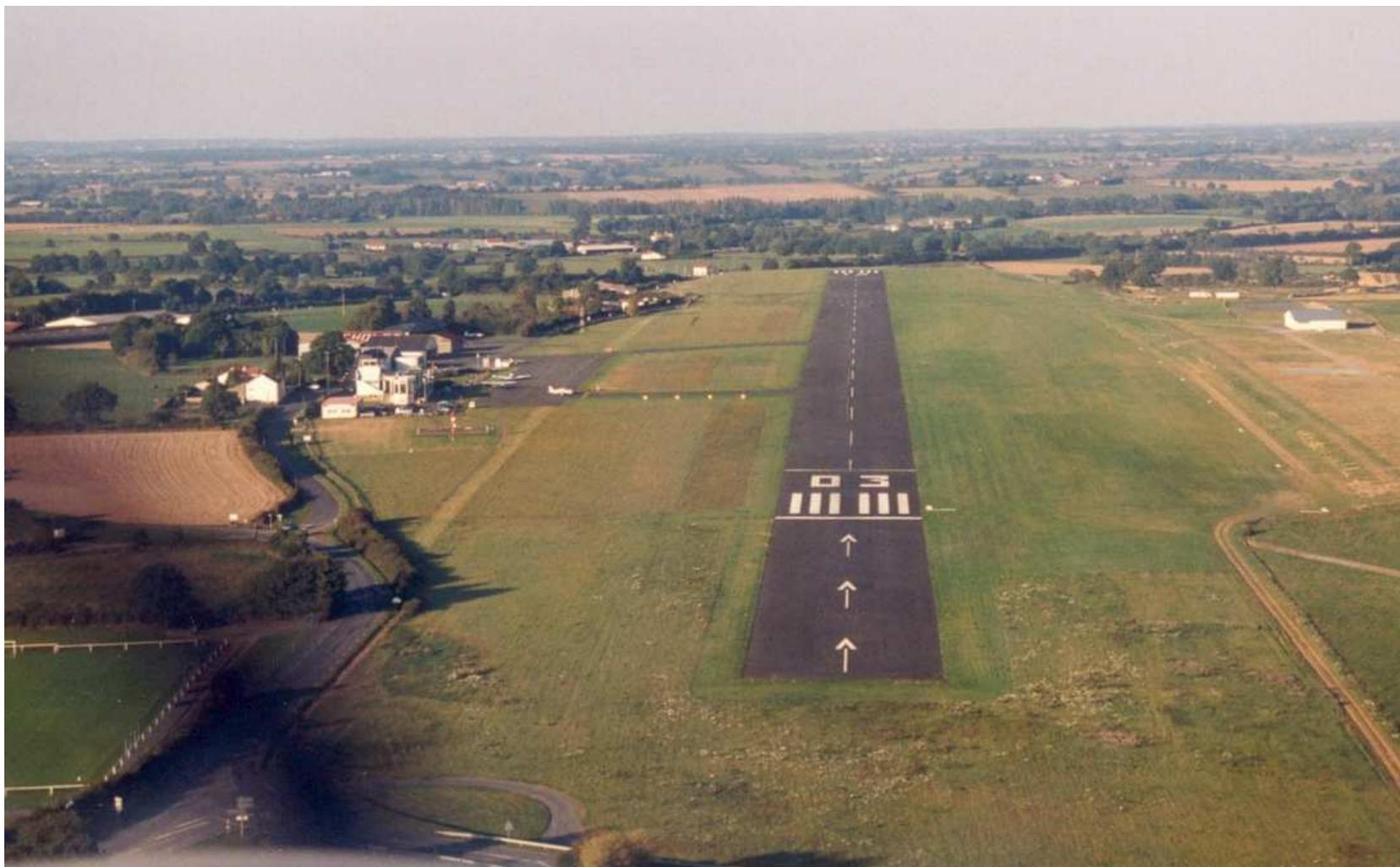
Vue de la plateforme en 2013 : Piste en dur de 1380 m x 30 m, procédures d'approches aux instruments (VOR et GNSS), NDB, système PAPY, Balisage nuit automatisé, Piste herbe 1000 m x 80 m, piste aéromodélisme 120 m x 10 m et station de carburant 100LL et Jet A1.
