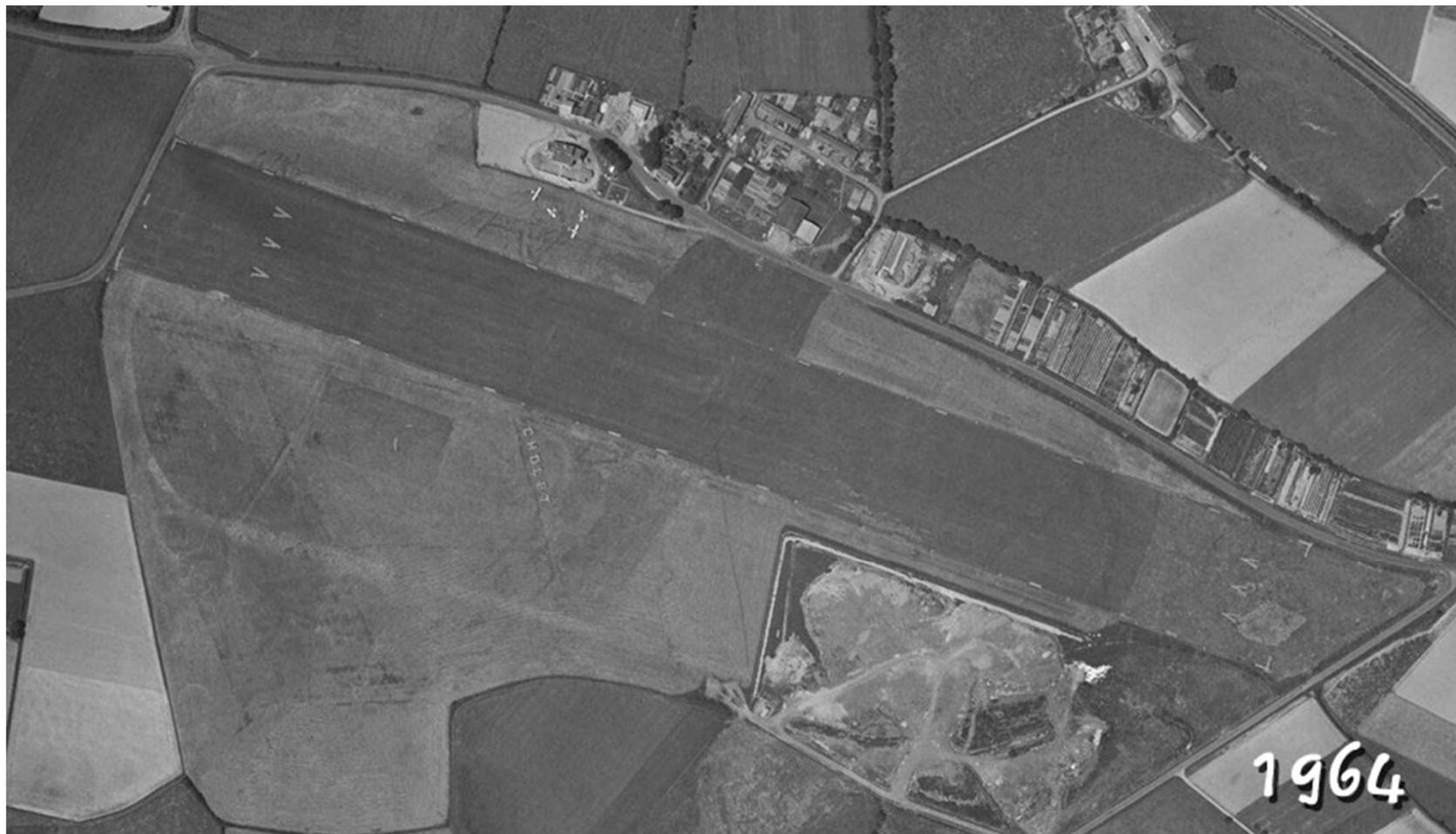
En 1965, le champ en herbe de l'aérodrome laisse place à une piste avec un revêtement en dur bitumé de 700m de longueur afin de permettre l'accueil d'appareils plus importants. Les largeurs de la piste et du taxiway ont été réduites. La piste en herbe de 600m est réalisée. En 1967, les hangars sont plus nombreux car la plateforme se développe. Le marquage au sol de Cholet a disparu.
