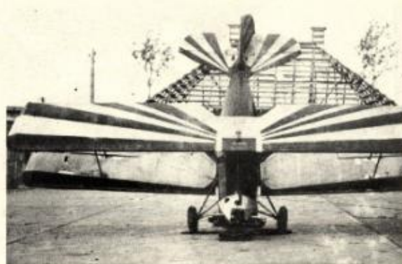
Printemps 1939, le RD-1 tout équipé : noter la simplicité du haubannage : deux mâts et des câbles tendus en X entre chaque aile. La décoration à bandes rayonnantes rouge et blanche n'est pas sans rappeler les hélices de voilure de Marcel Doret.
