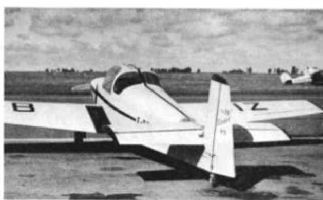
F-BBIZ, le Condor n° 3, un D-61 encore démuné de l'arête dorsale devant la dérive qui équipera ceux construits par le suite.
