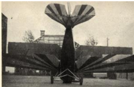
Les dessous du RD-1 ! Outre le train et les larges ailerons, ce document nous révèle un empennage aux gouvernes surdimensionnées. Noter le plan fixe horizontal contreventé par câbles à l'intrados comme à l'extrados.
